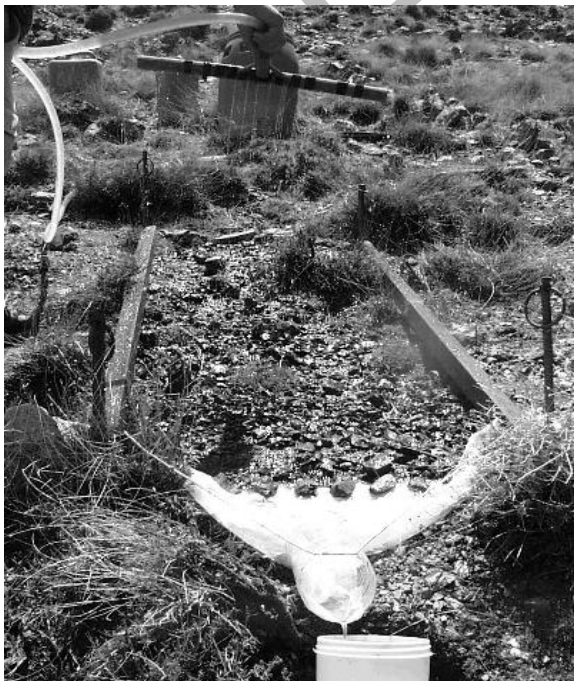
Figure1: Dispositif du test d'infiltrométrie. On distingue en haut de la placette le bidon d'eau, au dessus de la placette la rampe d'arrosage, et en bas le collecteur de ruissellement. System of the infiltrometer tests. The water tank can be seen above the top the plot, the irrigation ramp is above the plot, and the runoff collector at the bottom.
