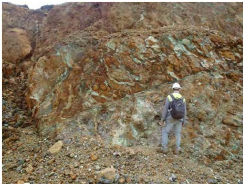
Figure 64 : Massif de Poro, mine La Française, fosse Stanislas. Différence d'altération de part et d'autre d'une faille « plate » serpentinisée et minéralisée en garniérite/silice brune.
