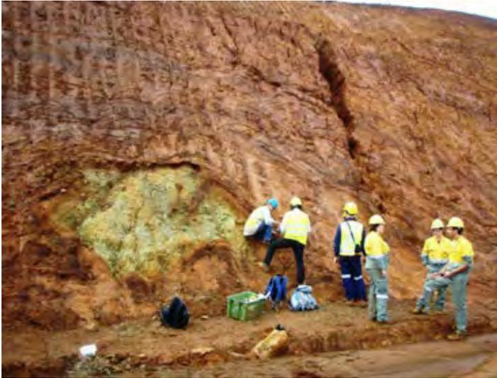
*Affleurement de harzburgite altérée moulée dans la latérite de transition.*
