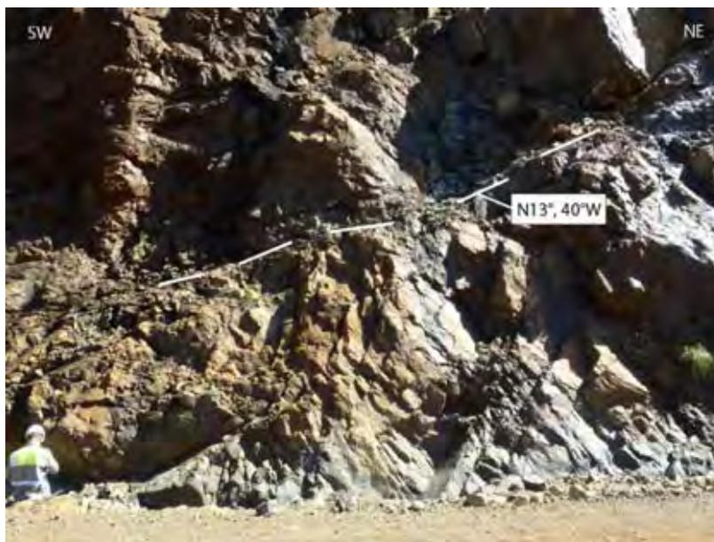
Figure 61 : Massif de Poro, mine La Française, piste minière. Structure « plate » et bréchique affectant la base du massif. Les péridotites présentent un faciès très serpentinisé.
